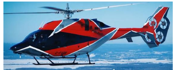
L'hélicoptériste Américain Bell étudie nouveau concept de rotor anti-couple qui consiste en un fenestron avec 4 rotors entraînés électriquement
